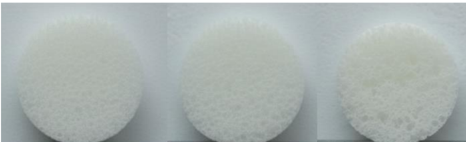
Fig 2. a) Pure PCL b) PCL/10% HA, and c) PCL/20% HA
